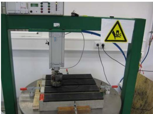
Bild 4: Prüfstand für Dauertrittbelastung
