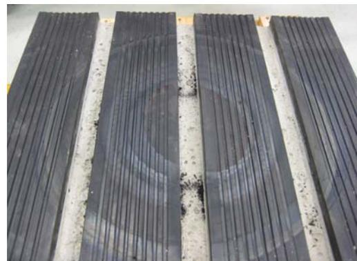
Bild 5: Bodenbelag nach der Dauertrittbelastung mit einer Million Tritten
