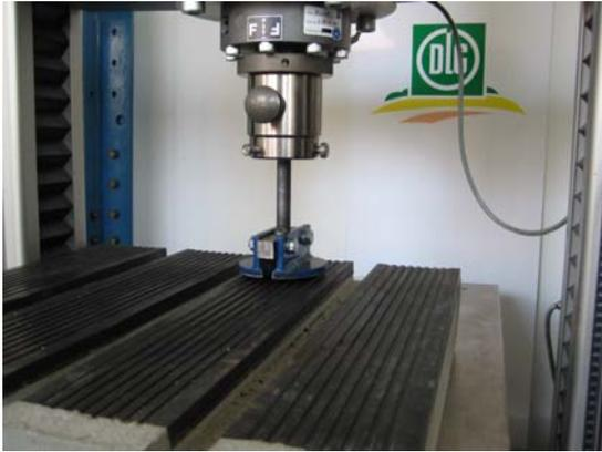
Bild 3: Messung der Verformbarkeit
