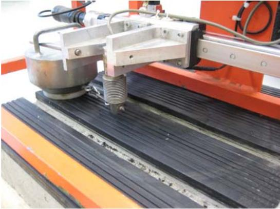
Bild 7: Messung Rutschfestigkeit mit DLG ComfortControl
